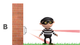
B - L'allarme SI ATTIVA quando entrambe le zone rivelano un movimento
